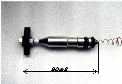
まず、純正のレリーズシリンダーを分解し、図のように純正レリーズシリンダーのカップ部分の黒いパッキンを、OS専用プッシュロッドに取り付け、図の状態にしたもの(90mmの長さに固定)をレリーズシリンダーに再び挿入して下さい。この時、純正のアルミ製カップは取り除いて下さい。使用しません。
